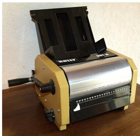
Machine à photocopier à l'alcool. Procédé de reproduction nécessitant une feuille paraffinée, une feuille de papier carbone, et de l'alcool. Pour dupliquer un document dans cette machine rotative, l'alcool à brûler permet d'imprégner le papier blanc pour diluer l'encre du papier carbone.
